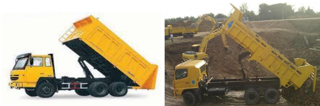
รูปที่ ๕.๒.๒-๑๑ รถบรรทุกเทท้าย (Dump Truck)
