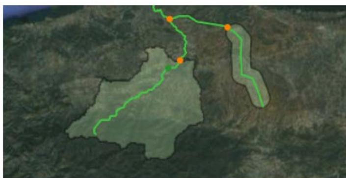
รูปที่ 4.7-1 Illustration of catchments in a MIKE HYDRO model
