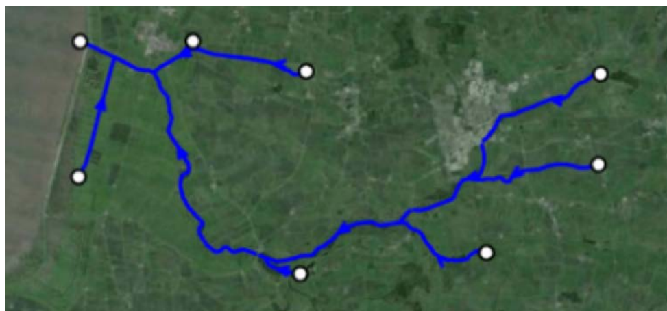
รูปที่ 2.2.9-1 River network with 'Open end' boundary locations (black circles)
