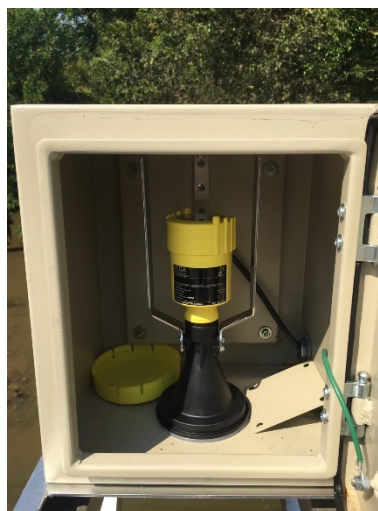
รูปที่ 3.3-2 การติดตั้งอุปกรณ์ตรวจวัดระดับน้ำแบบ Radar Sensor
