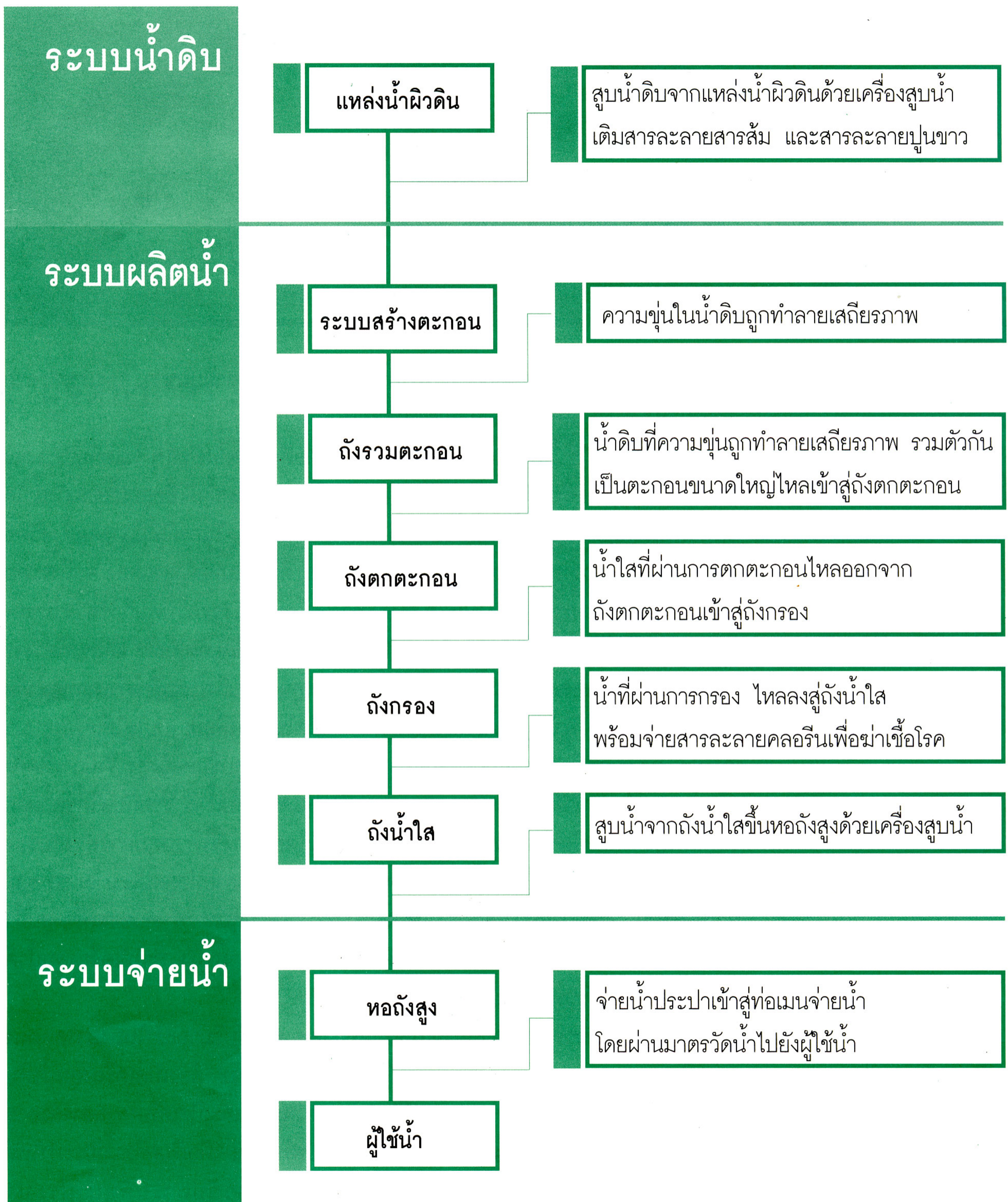
รูปที่ 1 กระบวนการผลิตน้ำประปา
