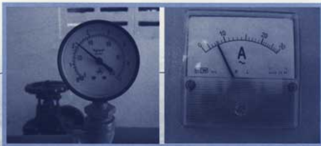
รูปที่ 59 สังเกตเข็มของ เกจวัดแรงดัน และแอมป์มิเตอร์
