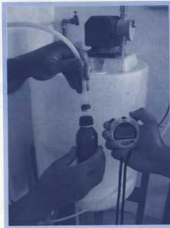
รูปที่ 31 การทำอัตราการจ่ายสารละลายคลอรีนโดยวิธีการตรวจจับเวลา
