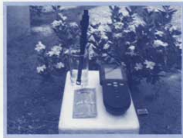
จุ่ม พี เอช มิเตอร์ ลงในสารละลายมาตรฐาน เพื่อปรับความถูกต้องของเครื่องมือ
