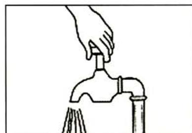
ข. เช็ดบริเวณกอกให้แห้ง ทำการฆ่าเชื้อโรคที่ปลายกอกน้ำ โดยใช้ไฟเผา หรือสำลีชุบแอลกอฮอล์ 70% เช็ดกอกน้ำ เพื่อเป็นการฆ่าเชื้อโรค ก่อนทำการสุ่มเก็บตัวอย่างน้ำ
