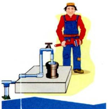
4) ตรวจสอบการประสานห่อที่ปากบ่อฯ และตามแนวห่อส่งน้ำไม่ให้มีการชำรุด ร้าวซึม เพราะจะทำให้เป็นการสูญเสียน้ำ และอาจจะทำให้มีน้ำจากภายนอกปนเปื้อน เข้าไปในห่อ
