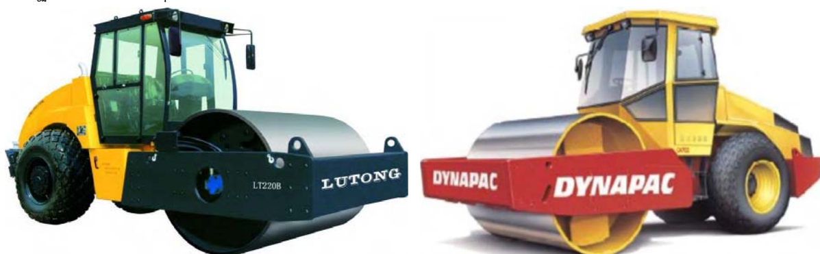
รถบดล้อเหล็กเรียบแบบสันสะเทือน (Vibrate Smooth Steel Wheel Rollers)
