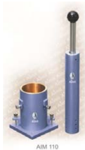
รูปที่ 12-24 อุปกรณ์และวิธีการทดลอง Compaction test (ที่มา: http://www.denichsoiltest.com/Compaction-Test.html )
