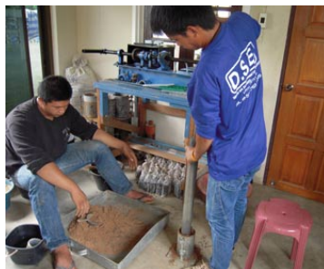
รูปที่ 12-24 อุปกรณ์และวิธีการทดลอง Compaction test (ที่มา: http://www.denichsoiltest.com/Compaction-Test.html )
