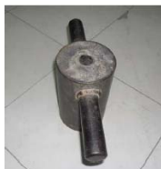
ตั้มน้ำหนัก ๑๐ กก. (Pile Hammer)
