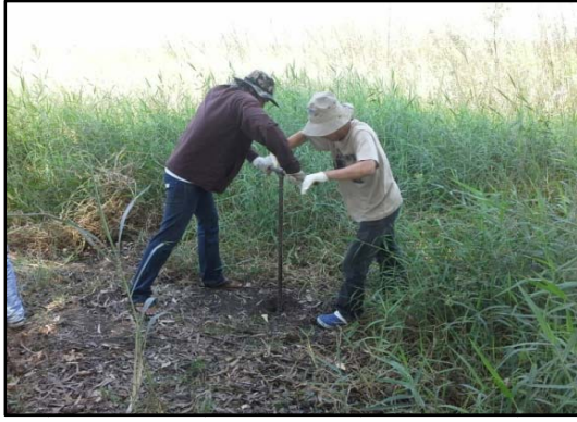
รูปที่ 12-6 แสดงการเจาะเก็บตัวอย่างดินด้วยสว่านแบบมือหมุน
