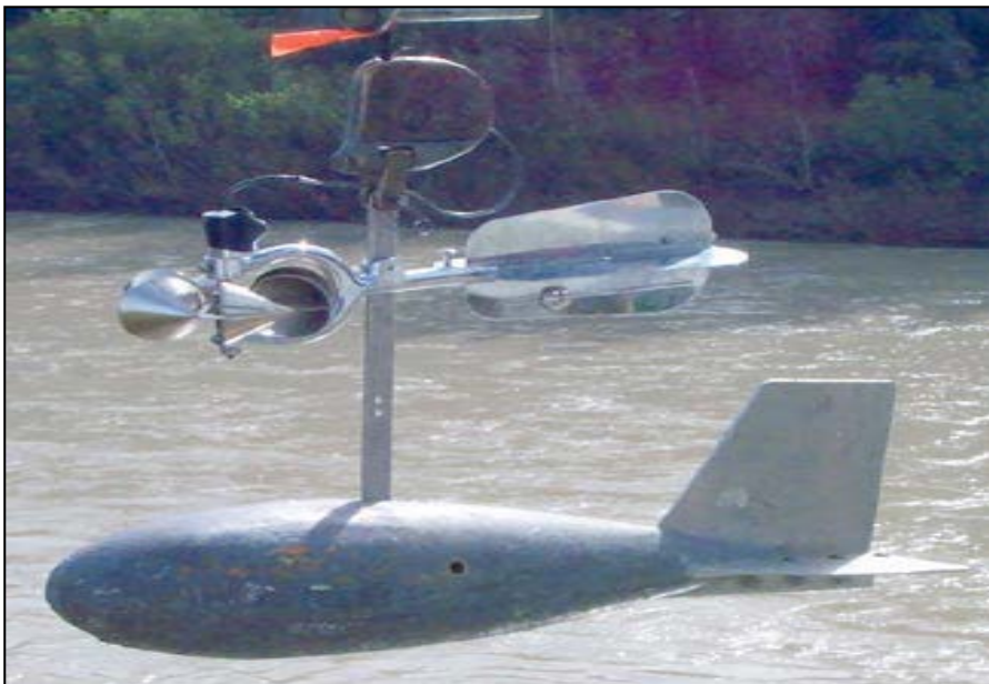
รูปที่ 26 แสดงส่วนประกอบของชุดวัดกระแสน้ำแบบ Price
