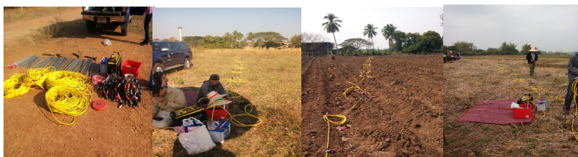
รูปที่ 12-3 การสำรวจธรณีฟิสิกส์โดยวิธีการวัดค่าความต้านทานไฟฟ้า
