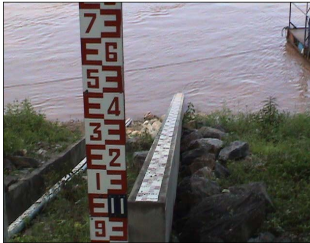
รูปที่ 19-2 แสดงลักษณะของแผ่นวัดระดับน้ำแบบเอียง
