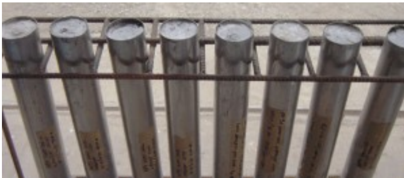
รูปที่ 12-8 การเก็บตัวอย่างแบบคงสภาพโดยใช้กระบอกบาง (thin wall tube sampler) (ที่มา : http://www.denichsoiltest.com )
