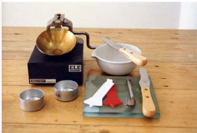
รูปที่ 12-12 การทดสอบอัตรเตอร์เบิร์ก (Atterberg's Limits) ที่มา: http://www.gerd.eng.ku.ac.th/Cai/Ch04/ch045_A_method.htm
