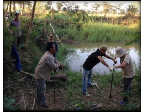
รูปที่ 12-6 แสดงการเจาะเก็บตัวอย่างดินด้วยสว่านแบบมือหมุน
