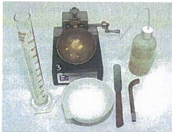
รูปที่ 8 เครื่องมือเคาะหาขีดจำกัดเหลว ครอบบรจุดิน ถ้วยกระเบื้องเคลือบ ใบพายกวนดิน เครื่องมือปาตร่องดิน และชวดบรรจุน้ำ
