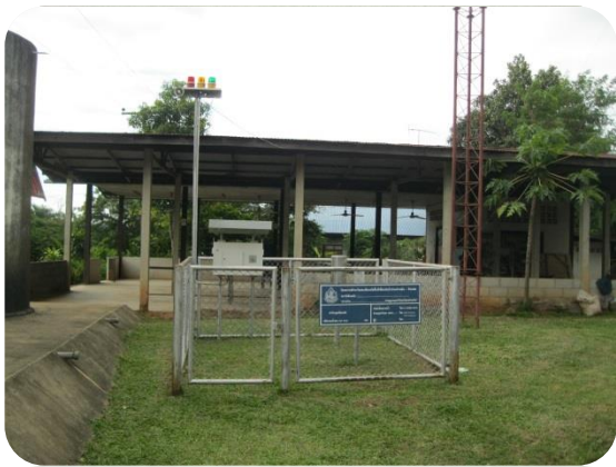
แบบที่ 1 สถานีเตือนภัยล่วงหน้า ด้วยปริมาณน้ำฝน
