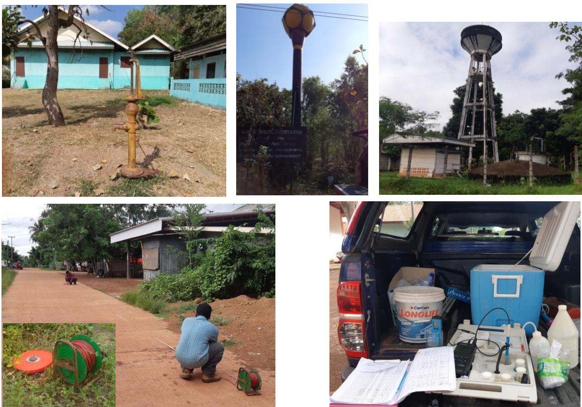
รูปที่ 3.2-1 บ่อน้ำบาดาลรูปแบบต่างๆ และอุปกรณ์วัดระดับน้ำ คุณภาพน้ำและเก็บตัวอย่างน้ำในสนาม
