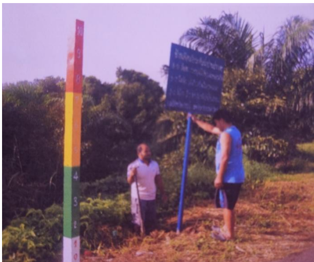
ภาพที่ 8.6 ป้ายเตือนอุทกภัย โดยเทียบเคียงกับระดับน้ำริมถนน ที่บ้านปากเลข อ. พะโต๊ะ จ. ชุมพร
