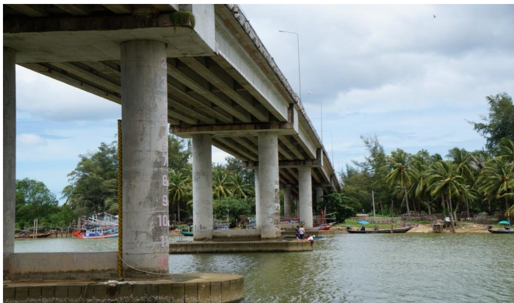
ภาพที่ 8.4 ไม้วัดระดับน้ำที่สะพานหลวงโรงน้ำแข็ง บริเวณปลายน้ำ
