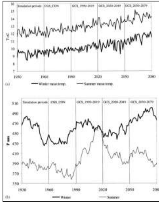
รูปที่ 2-16 ผลการจำลองปริมาณน้ำฝนและอุณหภูมิที่เปลี่ยนแปลงไปตั้งแต่ปี ค.ศ. 1930-2080
