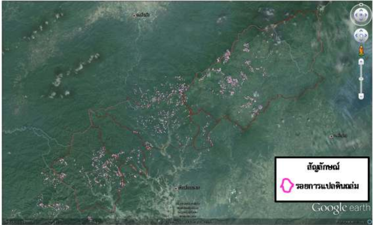
รูปที่ 3-39 ผลการแปลข้อมูลรอยดินถล่มจากเหตุการณ์ดินถล่มวันที่ 23 พฤษภาคม 2549 (จ.อุตรดิตถ์)
