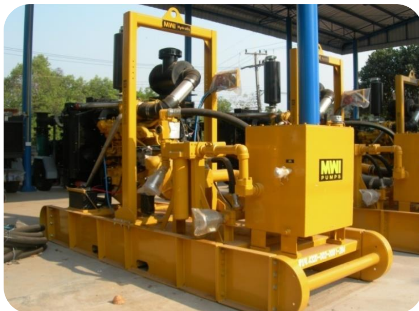
เครื่องสูบน้ำชนิดไฮดรอลิก ขับเคลื่อนด้วยเครื่องยนต์ดีเซลขนาด ๓๐ นิ้ว ความสามารถในการสูบ ๑.๕ ลบ.ม/วินาที ความสามารถในการส่งสูง ๕ เมตร อัตราสิ้นเปลืองน้ำมันเชื้อเพลิง ๔๘ ลิตร/ชม.
