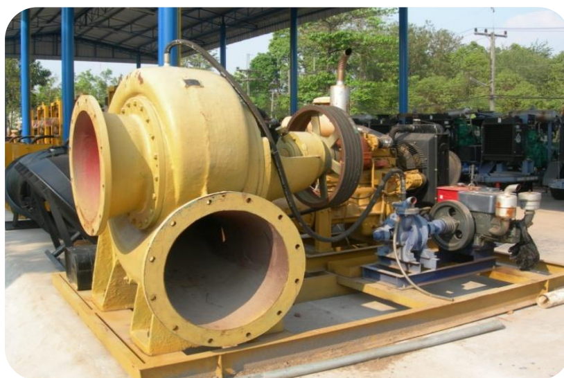
เครื่องสูบน้ำขับเคลื่อนด้วยเครื่องยนต์ดีเซลขนาด ๒๖ นิ้ว ความสามารถในการสูบ ๓,๓๐๐ ลบ.ม/ชม. ความสามารถในการสูบส่งสูง ๕ เมตร อัตราสิ้นเปลืองน้ำมันเชื้อเพลิง ๑๕ ลิตร/ชม.
