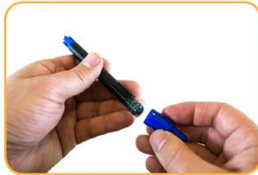
2. ถอดฝาครอบกันฝุ่นออกจาก พอร์ตกลาง
