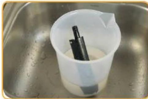
6. แช่หัวตรวจวัดในน้ำยาจัดเก็บอย่างน้อย 1 ชั่วโมง ก่อนทำการปรับเทียบใหม่ และนำไปใช้งาน
