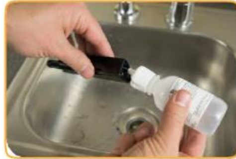
3. ใส่สายลงไปให้ลึกเพื่อลดการเกิดฟองอากาศ
