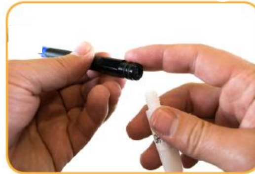
3. ทาสารหล่อลื่นบนบอริง
