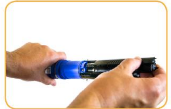
8. ติดตั้งหัวตรวจวัดจนครบทุกช่อง
