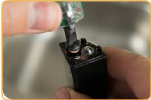
1. ใช้ไขควงปากแบนหมุนเอา Junction ออก
