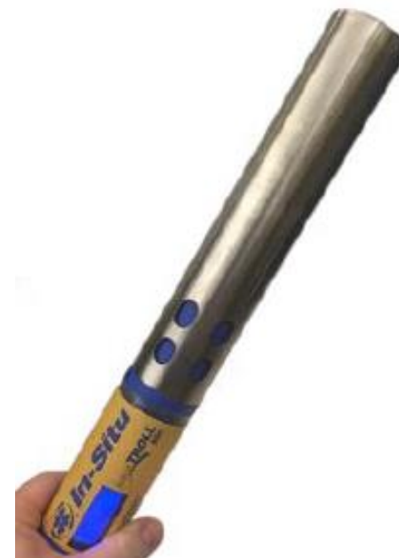
เก็บหัวตรวจวัดเมื่อไม่ได้ใช้งาน และเป็นถ้วยสำหรับสอบเทียบ
