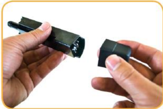
5. ถอดฝาครอบกันฝุ่นออกจาก หัวตรวจวัด
