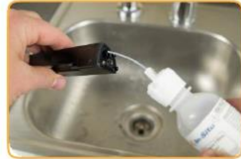
4. เติมสารละลายใหม่ลงไป โดยค่อยๆบีบอย่างช้าๆจนเต็ม
