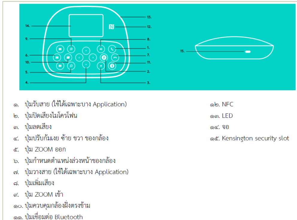
รูปที่ 6.5-7 ภาพส่วนประกอบอุปกรณ์ระบบเสียง
